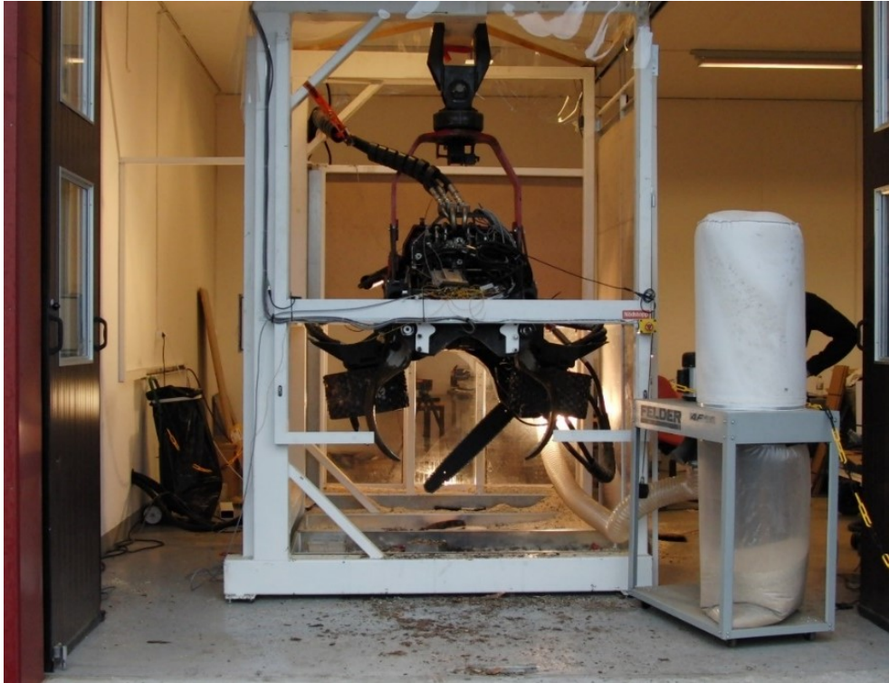
Figur 5. Skördaraggregatet upphängt i en ställning.
