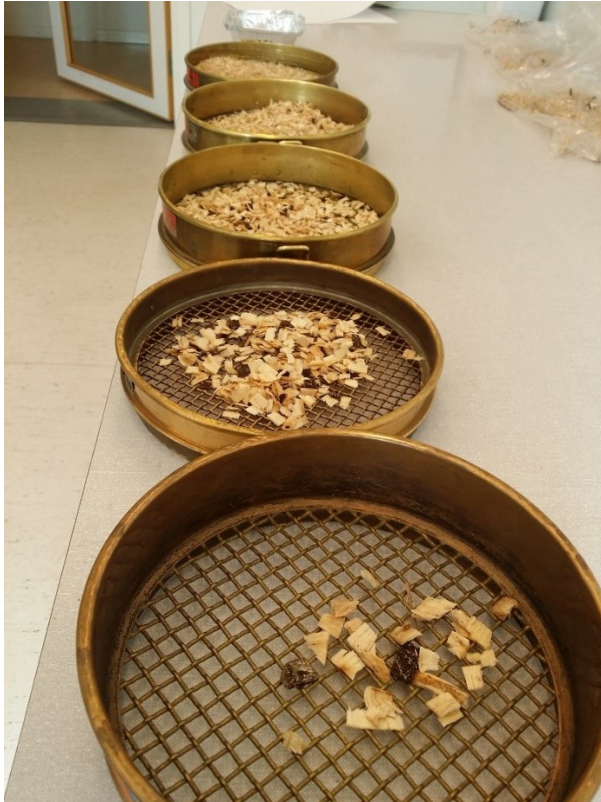
Figur 11. Bild på den sikt som användes och som hade fem siktskålar med varierande nätstorlek. Siktskålen med 8 mm 2 nätstorlek längst fram i bilden.
